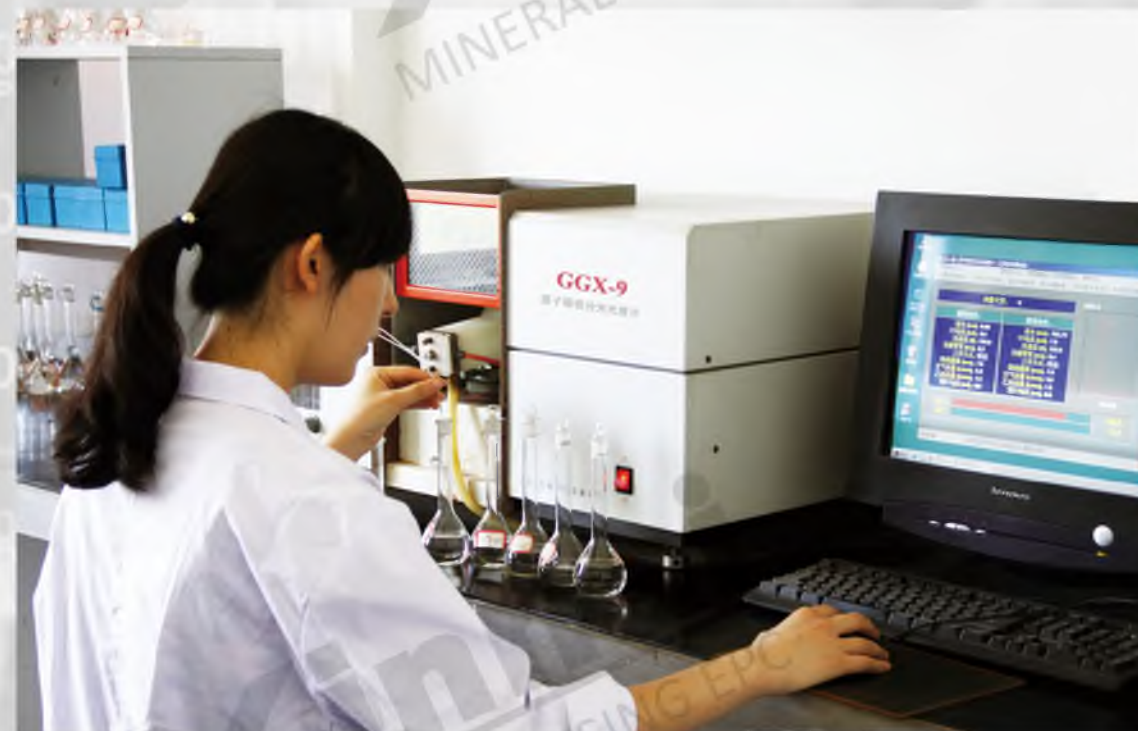
◆ 鑫海技术人员正在使用原子吸收分光光度计进行矿样分析
