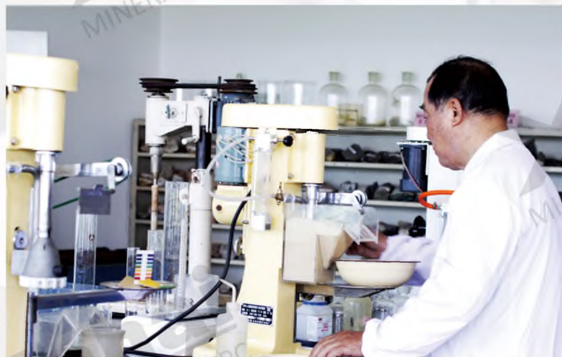
鑫海技术人员正在进行矿样浮选试验
